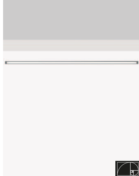
Darstellung inklusive Befestigungswinkel. Deckenausschnitt = Leuchtenlänge + 2 mm, Breite 71 mm, Höhe min. 105 mm
