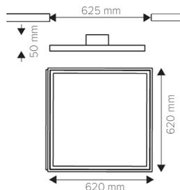
Bei Verwendung des Einbaurahmens ist eine Mindesteinbautiefe von 200 mm erforderlich. Deckenausschnitte 612 mm bzw. 635 mm.
